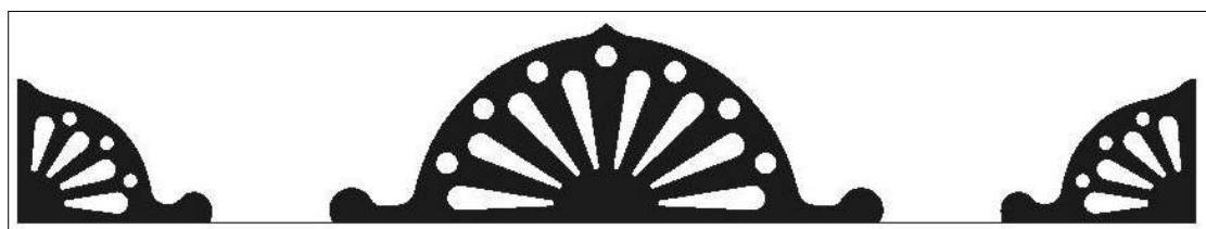
Рис. 21. Круги-капельки между лучами-пропилами при ровной дуге абриса
